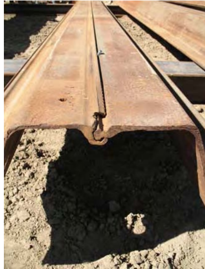
Paired PZ piles
